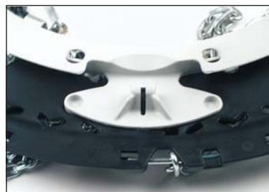
Dann den grauen Verwahrung im Uhrzeigersinn drehen, bis beide Verriegelungsknöpfe eingerastet sind.
