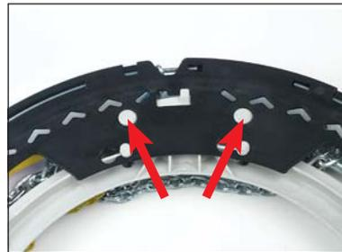
Den grauen Verwahrung durch Drücken der beiden Verriegelungsknöpfe (Pfeil) neben dem Arretierungsschlitz (von der Rückseite her) und gleichzeitigem Drehen gegen den Uhrzeigersinn von dem schwarzen Trägerring lösen. Den grauen Verwahrung auf der gegenüberliegenden Seite einsetzen.
